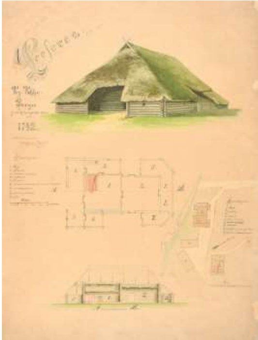
1742. gadā celtās Cēsu apriņķa Liezēres pagasta Vecvēķu Serga senās dzīvojamās ēkas (rijas) kopskats (augšā), plāns (vidū), garengriezums (apakšā). Labajā apakšējā stūrī skicēts sētas apbūves plāns ar seno dzīvojamo riju, kūtīm, klēti un jauno, savrup celto dzīvojamo māju. Zīmēja Jānis Krēsliņš. 1894. gads. Latvijas Nacionālā vēstures muzeja krājums
